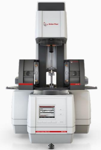
포트폴리오를 완성하는 모듈식 소형 레오미터 MCR 502e Power를 통해 저희 레오미터는 최신 아스팔트 및 역청 분석에서 발생하는 모든 요구를 충족합니다.
