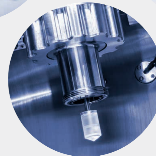
RheoSAXSモジュールによる液体の 粘弾性と散乱の同時測定
