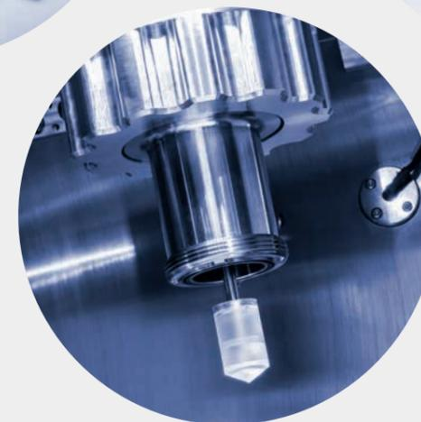
针对液体的流变学和散射实验联用的 RheoSAXS 模块
