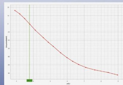
Escaneado del pH con indicación del punto isoelectrico (pH vs. potencial zeta)
