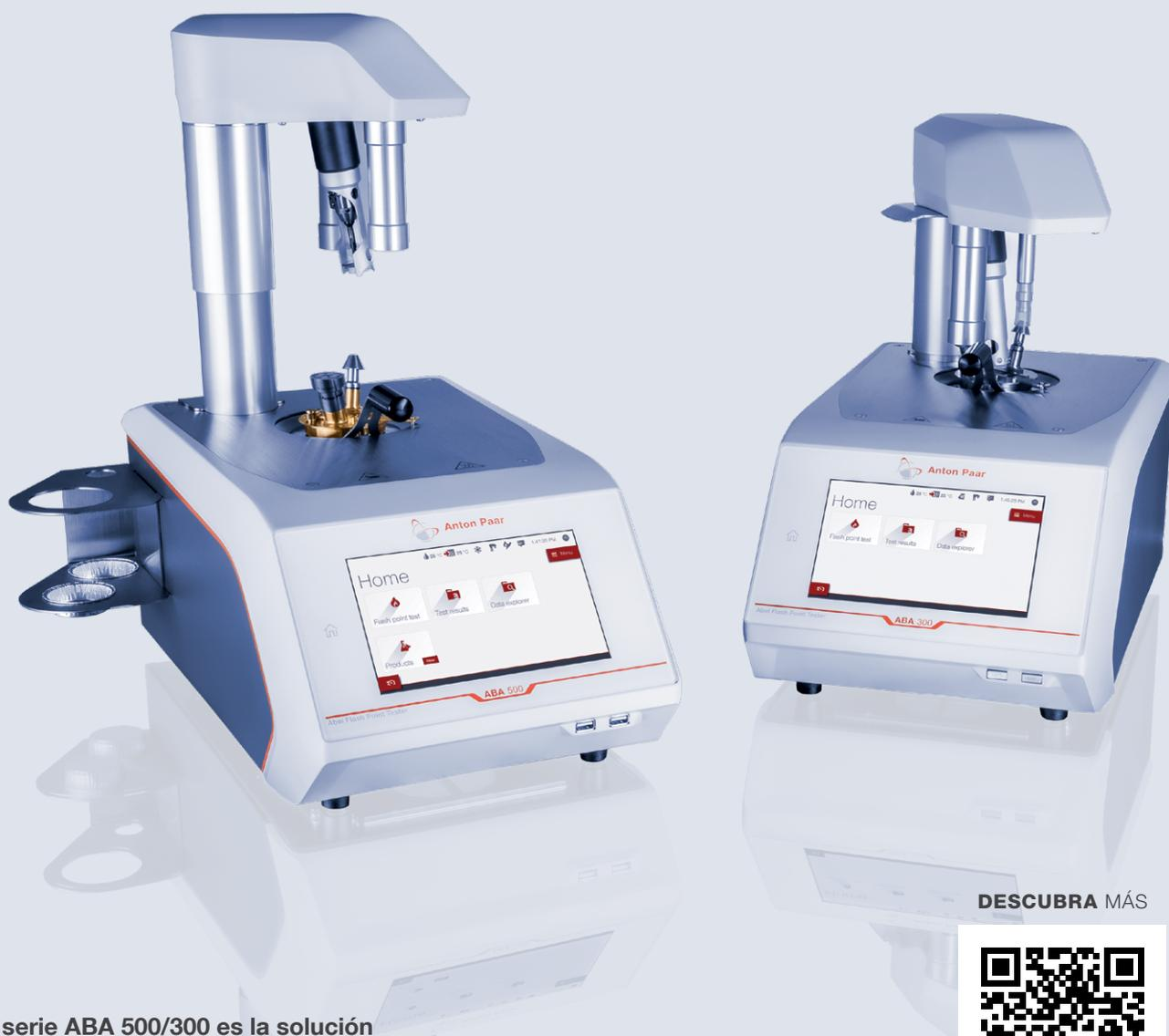
La serie ABA 500/300 es la solución de primera línea para pruebas Abel automáticas y de alta precisión del punto de inflamación de muestras como combustibles para aviones, disolventes, sabores y fragancias y productos químicos.
