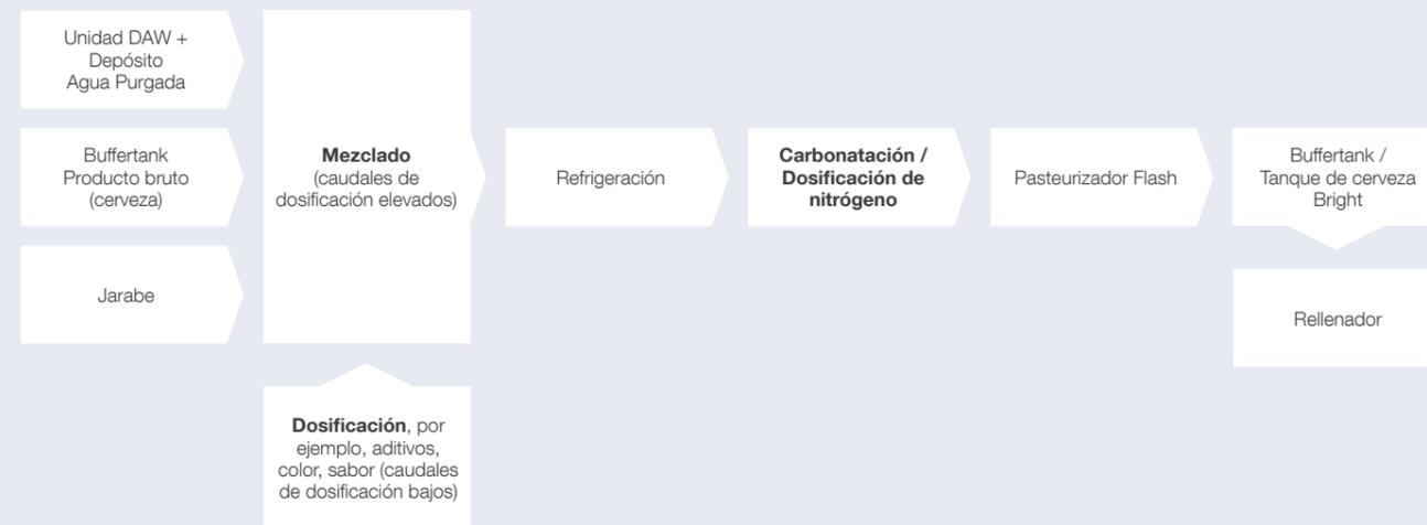
Dado que los sistemas de licuado, carbonatación, dosificación de sabores, tanques intermedios y desaireación del agua están sincronizados y se operan por una sola interfaz hombre-máquina (HMI), usted puede integrar cualquier módulo Flex-Blend 7000 en cualquier sistema integral. Configure Flex-Blend 7000 para que interactúe con un sistema de control de supervisión para su funcionamiento a distancia, o deje que asuma el control de los sistemas de proceso adyacentes.
