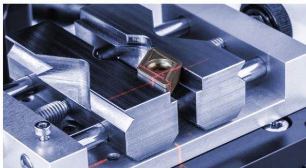
Ahora apunte al área que se va a medir con el láser. La indentación se establece en la intersección de las dos líneas láser. Añada una cámara, para observar más de cerca la zona de abajo.
