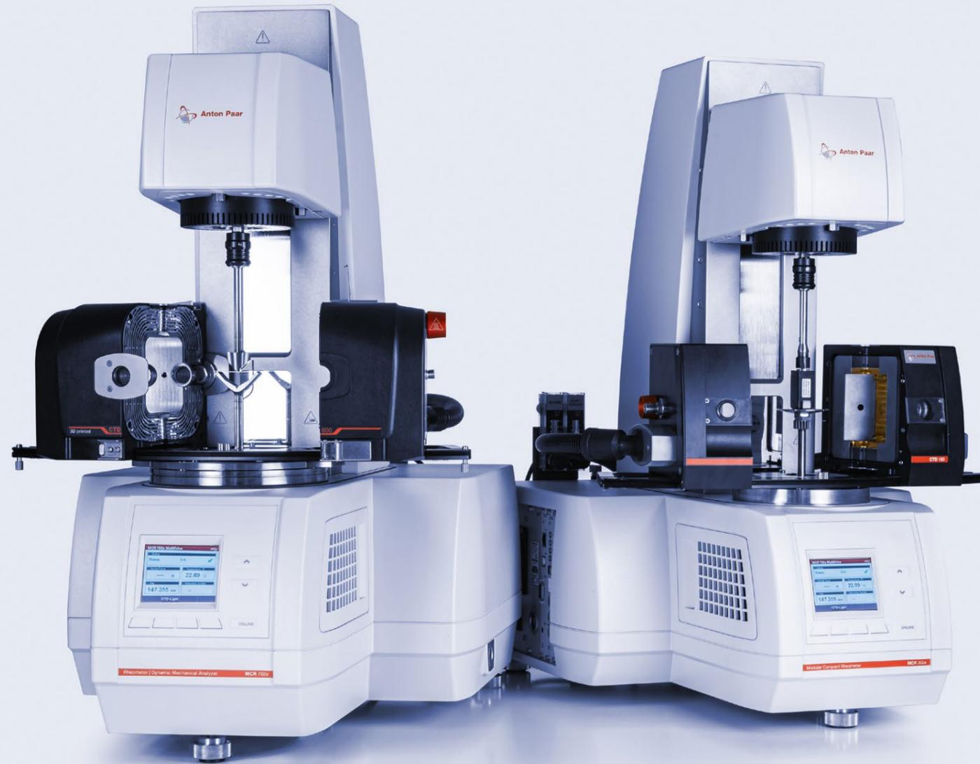
微型万能试验机 UTM MICRO 可进行扭转、拉伸、压缩、弯曲、剥离、剪切、撕裂和摩擦测试
