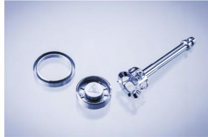
**小剪切池**, 可容纳 4.3 mL 样品, 适合小颗粒、珍贵样品, 法向荷载最高 30 kPa
