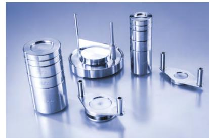
大小剪切池的 制备台和承重可用于时间固结测试, 而无需占用流变仪
