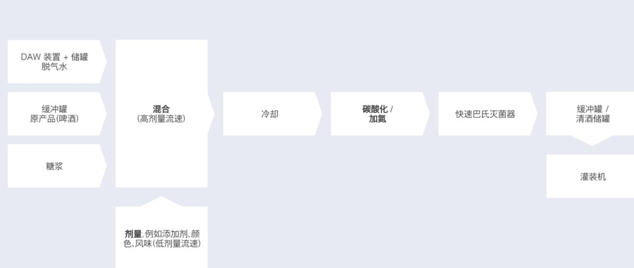
将任何 Flex-Blend 7000 系列模块与任何综合系统进行集成 - 搅拌机、碳酸化器、调味剂配料、缓冲罐和水脱气系统均通过同一人机界面 (HMI)。将 Flex-Blend 7000 系列设置为与监控系统交互以进行远程操作, 或者控制相邻工艺系统。
