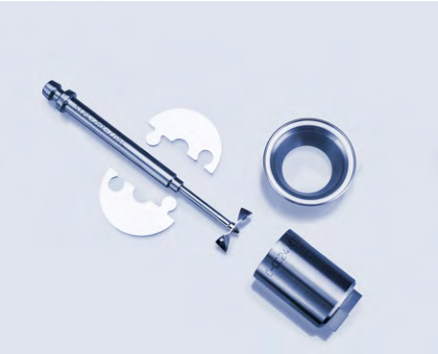
PFC 10 用於高溫下的基本流動性能量測量
