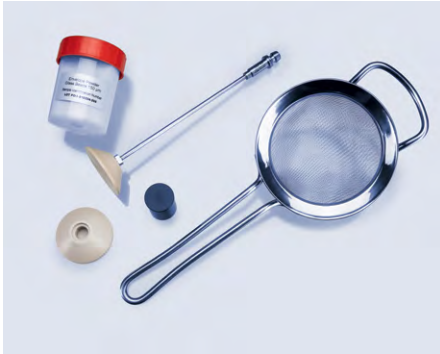
簡單且安全之測量方法，以可重複使用且自由流動之置換粉體，對固體進行總體密度表徵，樣品體積範圍為 0.3 cm³ 至 25 cm³。當樣品量至少佔總填充體積的 25% 時，可確保精確的體積測量，重複性高達 1%。 與氣體比重測量相結合，可以確定固體材料的絕對密度、孔隙率和比孔體積。
