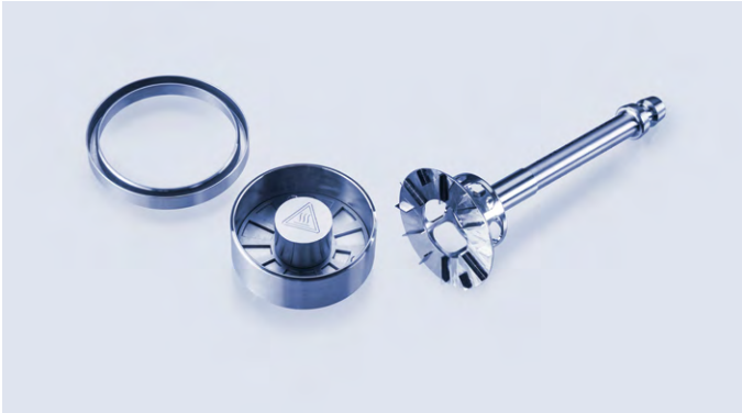
體積為 18.9 mL 的大型剪切池,適用於較大的顆粒
