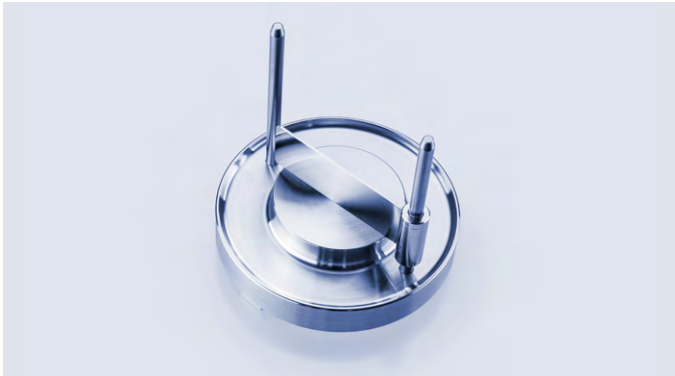
樣品製備台用於一致的樣品製備,減少操作員的影響
