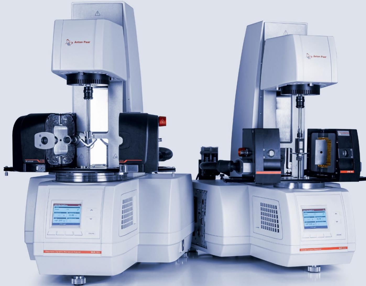
범용 시험기 UNIVERSAL TESTING MACHINE MICRO는 비틀림과 함께 인장, 압축, 굴곡, 박리, 전단, 인열 및 마찰 시험을 수행합니다.
