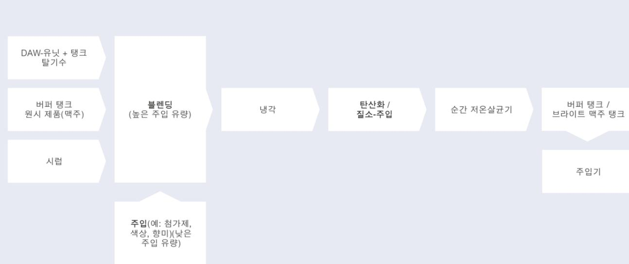
모든 Flex-Blend 7000 시리즈 모듈을 포괄적인 시스템에 통합하세요. 블렌더, 카보네이터, 향료 주입, 완충 탱크 및 물 deaeration 시스템이 단일 휴먼 머신 인터페이스(HMI)에 의해 동기화되고 작동됩니다. Flex-Blend 7000 시리즈를 설정하면 원격 작업을 위한 감독 제어 시스템 및 상호 작용 및 인접한 공정 시스템을 제어할 수 있습니다.
