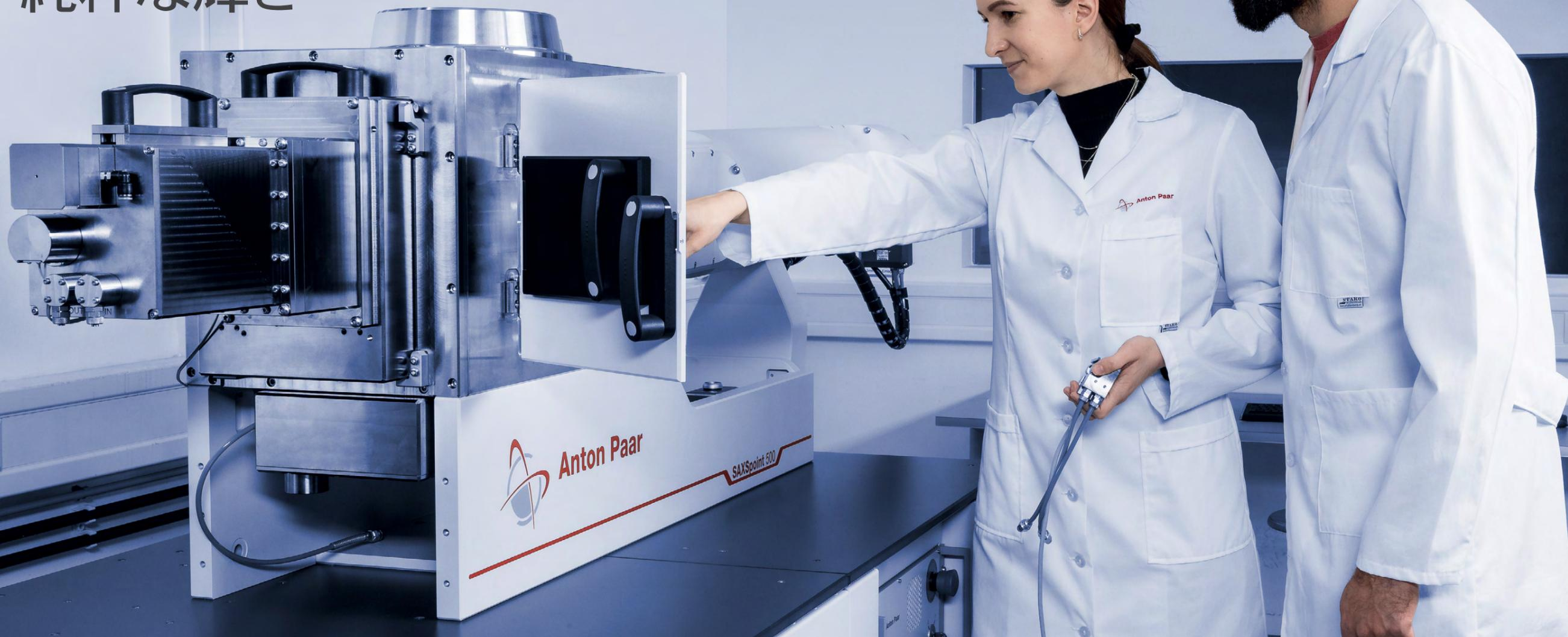
クラス最高のビームデリバリーシステムにより、ルーチンサンプルにも対応できます。最高水準のスペクトル純度 (>99.9% Cu K $\alpha$ ) を誇る、X線ビームと寄生散乱を低減したビームコリメーションにより、最小限の労力と最短の露光時間で、シンクロトロンと同等のデータ品質 (SAXS/WAXS/GISAXSを含む) を保証します。このSAXSシステムは、その優れたセットアップと業界をリードする光学系により、最もコンパクトなシステムサイズ (2.7x0.9 m) で、最大300 nm (d-spacing) までの構造の分解能を実現します。
