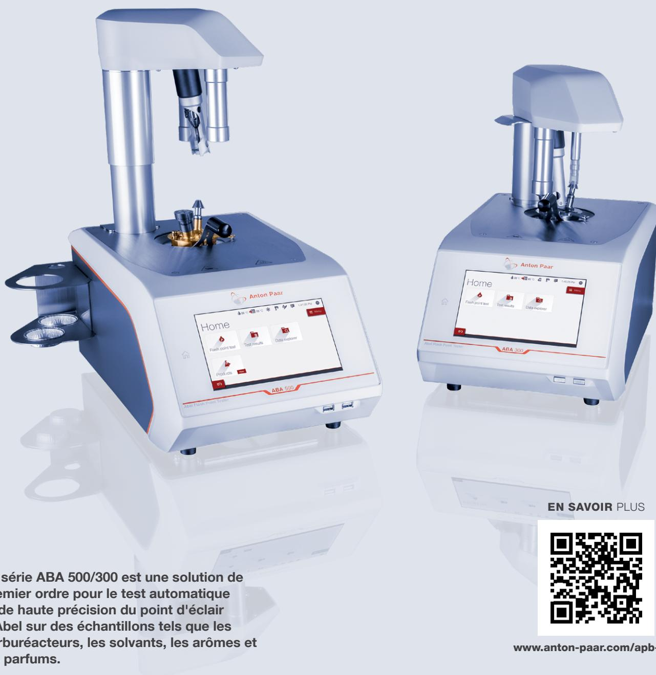
La série ABA 500/300 est une solution de premier ordre pour le test automatique et de haute précision du point d'éclair d'Abel sur des échantillons tels que les carburateurs, les solvants, les arômes et les parfums.
