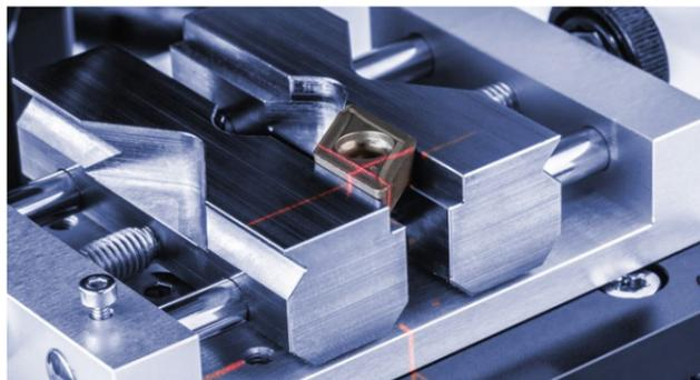
Visez maintenant la zone à mesurer avec le laser. L'indent est réalisé à l'intersection des deux lignes laser. Ajoutez une caméra, pour observer de plus près la zone.
