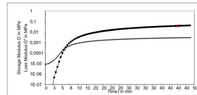
**Cura:** Reação de cura de um silicone a 90 °C. Análise automática do tempo de cruzamento (o) e do grau de cura (DOC) de 90% (x).
