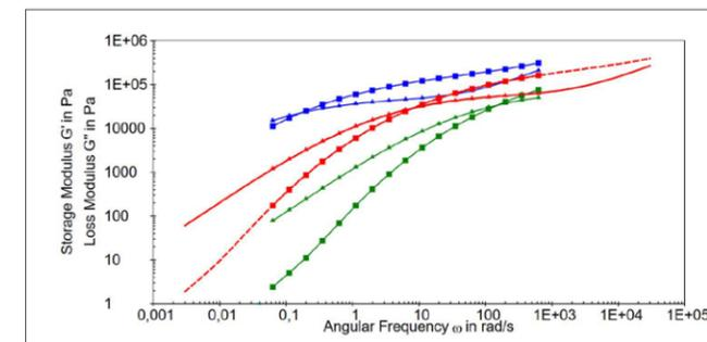
**Superposição de tempo-temperatura (TTS):** Varreduras de frequência do poliestireno a 160 °C (azul), 200 °C (vermelho), 260 °C (verde) e sua curva-mestre apropriada na temperatura de referência de 200 °C.
