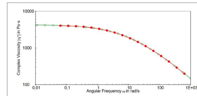
**Viscosidade complexa:** Viscosidade complexa do poliestireno a 230 °C. Análise automática da viscosidade de cisalhamento zero com base no modelo Carreau-Yasuda. (verde = regressão; vermelho = varredura de frequência)
