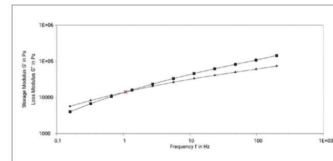
**Varredura de frequência:** Varredura de frequência de um polietileno a 180 °C. Análise automática do ponto de cruzamento.
