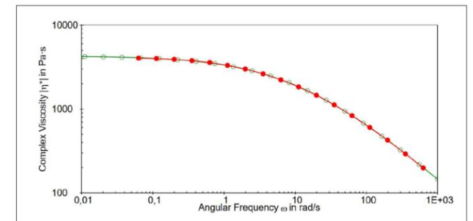
**Komplexe Viskosität:** Komplexe Viskosität von Polystyrol bei 230 °C. Automatische Analyse der Null-Scher-Viskosität auf der Grundlage des Carreau-Yasuda-Modells (Grün = Regression; Rot = Frequenzversuch).
