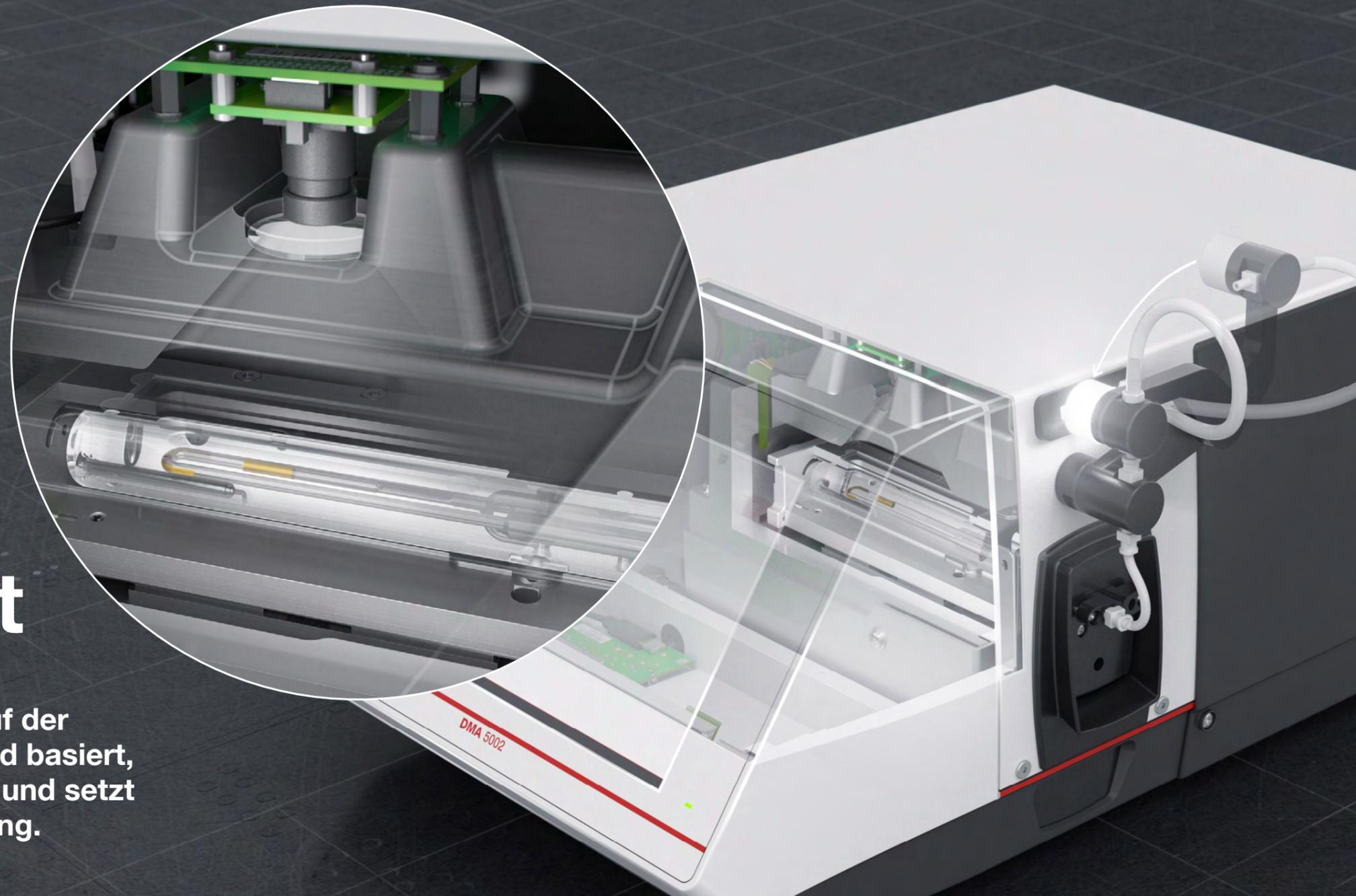
**Die Dichte ist der anerkannte Standardparameter für die Bewertung der Qualität eines Softdrinks. Sie ist die Grundlage für die hochpräzise Brix- und Diätmessung, die Sie mit unserer marktführenden Technologie durchführen können. Durch die Kombination von Schallgeschwindigkeit und Dichte können Sie den aktuellen Stand des Zuckerinversionsprozesses bestimmen, wodurch die manuelle Inversion der Vergangenheit angehört.**
