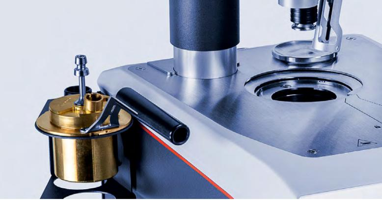
Die PMA 500/300-Serie besteht aus Flammpunktprüfern mit geschlossenem Tiegel, ausgestattet mit hochwertiger Technik und einem modernen Design. Die leistungsstarken Messgeräte bestimmen die zu erwartenden Flammpunkte von über Umgebungstemperatur bis zu 410 °C (PMA 500) bzw. 370 °C (PMA 300). Sie garantieren eine unkomplizierte, automatisierte Handhabung, maximale Sicherheit und unübertroffene Benutzerfreundlichkeit in Kombination mit einer selbsterklärenden Benutzeroberfläche.
