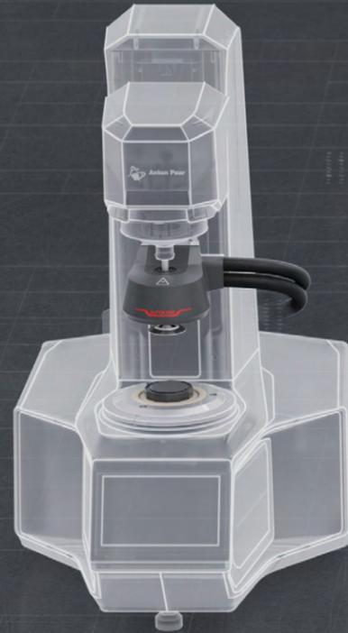
Dispositif de température Peltier
