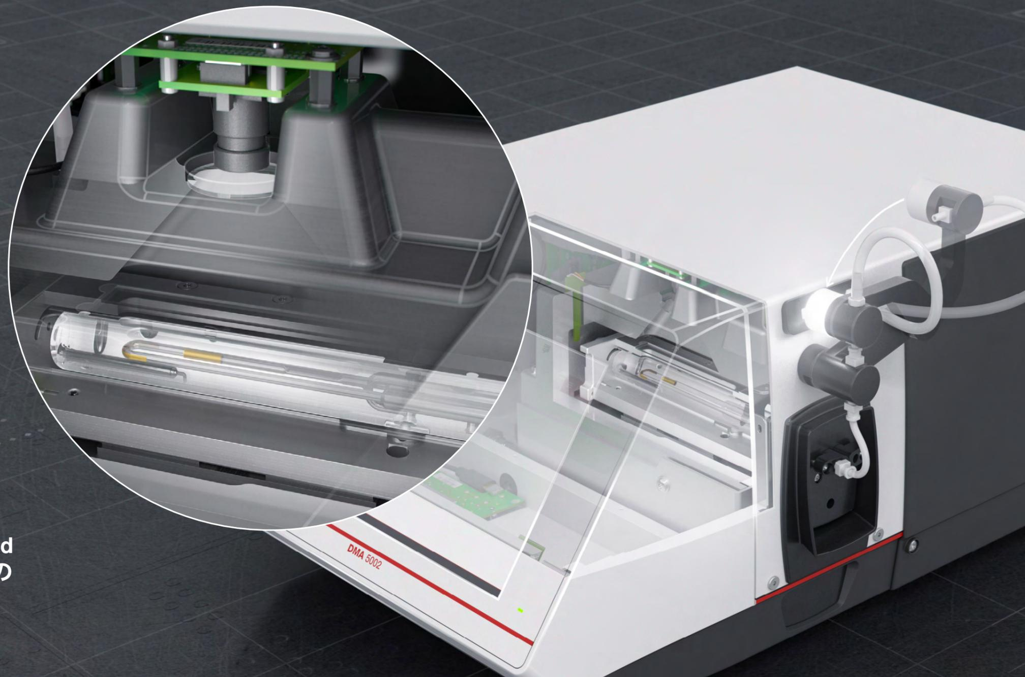
密度はソフトドリンクの品質評価の標準パラメーターとして認知されています。市場をリードする当社の技術では、密度をもとにBrix値とDiet値の高精度測定を行います。音速と密度を組み合わせれば、糖転化プロセスの進行の度合いを把握できます。手作業での測定はもう不要です。
