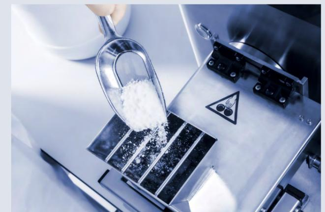
Messkneter für die Charakterisierung von Silica sowie anderen pulverförmigen Materialien
