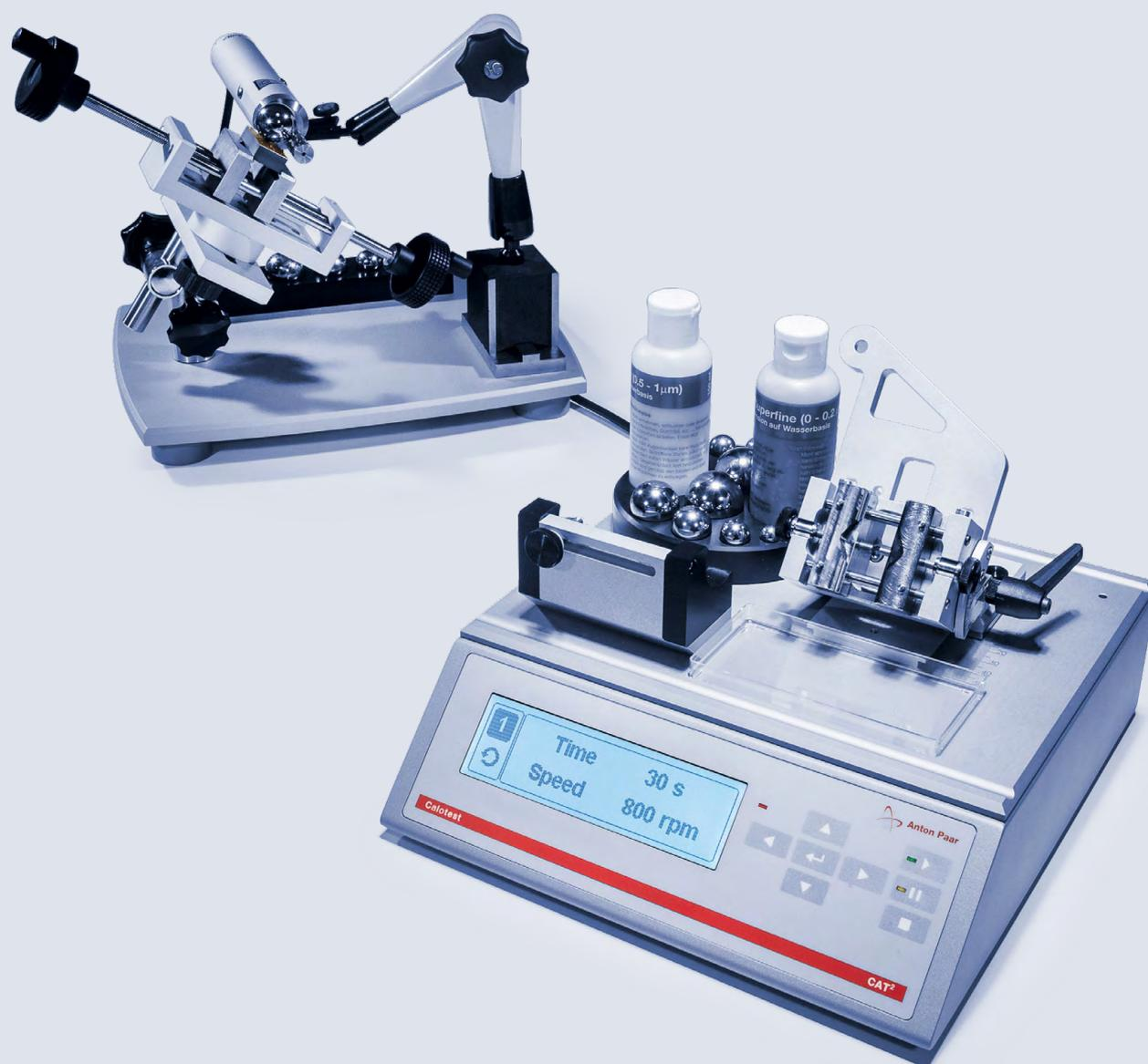
Caractérisez rapidement l'épaisseur de revêtements entre 0,1  $\mu\text{m}$  et 50  $\mu\text{m}$  couvrant un large éventail de matériaux.
