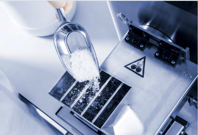
用於特性化二氧化矽和其他粉狀材料的測試腔體
