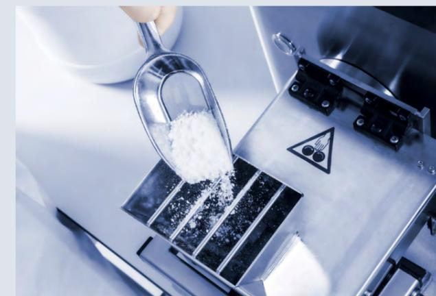
Mélangeur pour la caractérisation de la silice et d'autres matériaux pulvérulents
