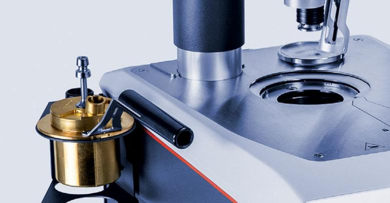
A série PMA 500/300 é um analisador de ponto de fulgor de copo fechado, equipado com tecnologia de ponta e design moderno. O instrumento de alta performance determina os pontos de fulgor das amostras acima da temperatura ambiente até 410 °C (PMA 500) e 370 °C (PMA 300), respectivamente. Ele garante manuseio simples e automatizado, segurança máxima e usabilidade incomparável em combinação com uma interface de usuário autoexplicativa.
