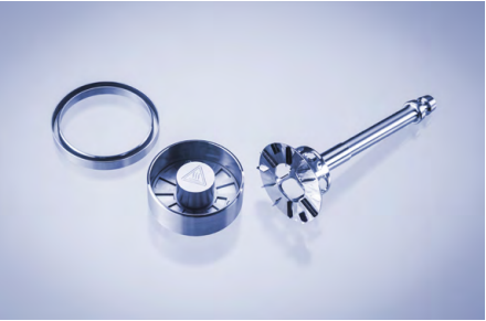
體積為 18.9 mL 的大型剪切池, 適用於較大的顆粒
