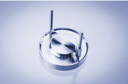
樣品製備台用於一致的樣品製備, 減少操作員的影響
