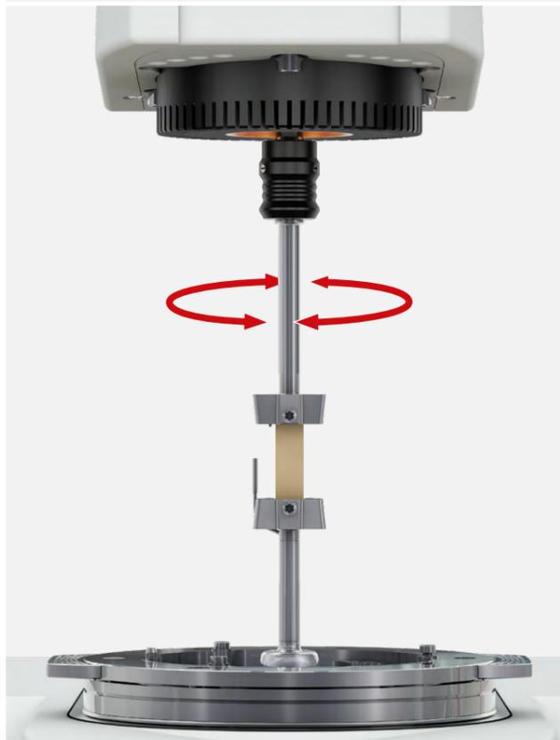
이 모드에서 선형 드라이브는 고정된 위치로 이동하는 반면 회전 드라이브는 전단 변형 또는 전단 응력을 제어하는 데 사용됩니다. 이 옵션은 고체 원형 및 사각형 고정장치(SCF, SRF), 플레이트-플레이트 또는 콘-플레이트 지오메트리와 같이 사용 가능한 고정장치와 결합하여 비틀림에 대한 동적 기계 분석과 유연학적 측정을 수행할 수 있는 가능성을 열어줍니다.
