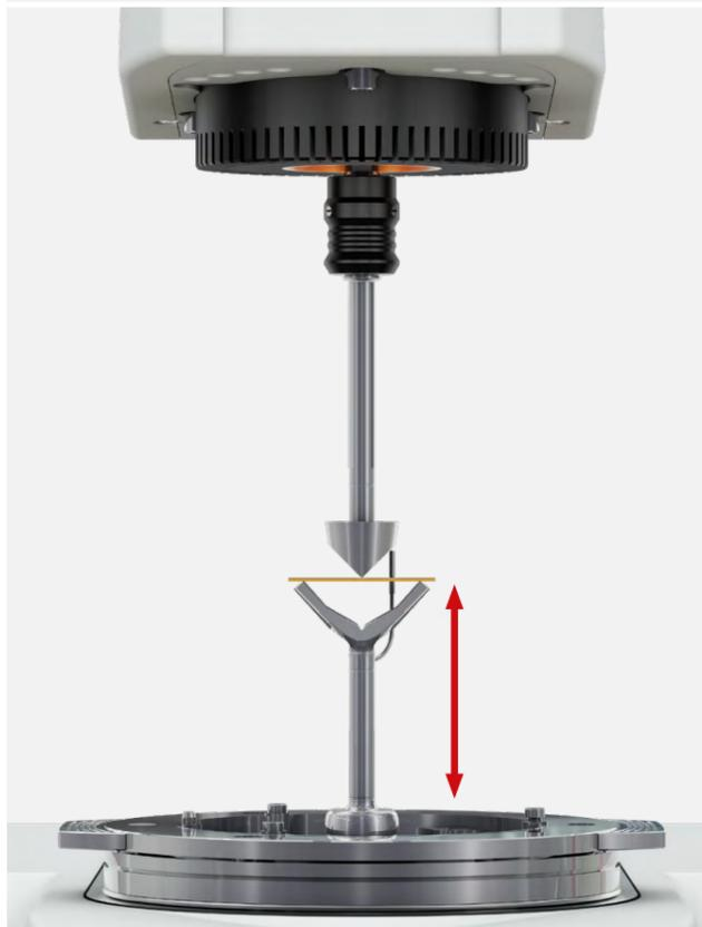
이 모드에서 회전 드라이브는 고정된 위치로 이동하는 반면 선형 드라이브는 하중이나 변위를 제어하는 데 사용됩니다. 3점 굽힘, 단일 캔틸레버, 이중 캔틸레버, 인장 상태의 DMA 고정장치 또는 압축 상태의 DMA 고정장치와 같은 측정 시스템 조합에서 이 모드는 '고전적인' 동적 기계 분석을 최대한 정교하게 수행하는 데 적합합니다. 또한 이 모드를 통해 크리프 및 회수 시험, 일정한 응력 또는 변형 측정, 열기계 분석을 수행할 수 있습니다.
