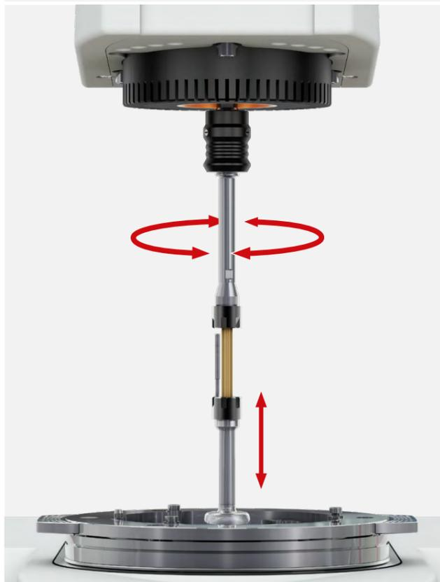
단단한 원형 및 직사각형 고정장치(SCF, SRF)를 사용하여 선형 드라이브와 회전 드라이브가 결합된 측정을 통해 단일 실험 내에서 온도, 주파수, 시간 또는 습도의 함수로서 복소 영(E\*) 및 복소 전단(G\*) 계수를 측정할 수 있습니다. 이러한 방식으로, 최초로 단일 시료를 사용하여 등방성 물질의 푸아송 비를 빠르고 정확하게 측정할 수 있습니다. 또한, 복합재와 같은 이방성 물질을 측정할 때는 방향에 따라 빠른 분석 및 보다 포괄적인 분석이 가능합니다.
