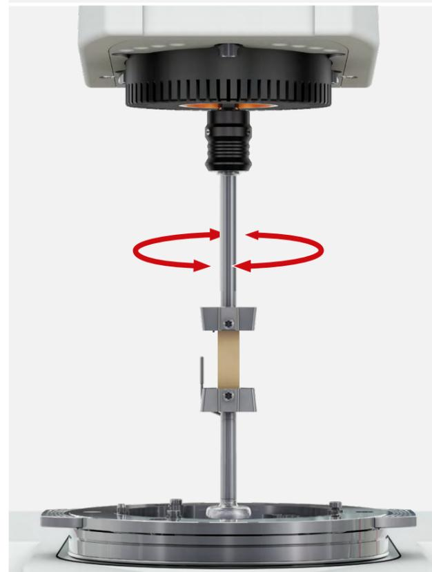
In questa modalità il motore lineare viene portato in una posizione fissa, mentre il motore rotazionale viene utilizzato per controllare la deformazione o lo sforzo di taglio. In combinazione con gli accessori disponibili come accessori solidi circolari e rettangolari (SCF, SRF) e le geometrie piatto-piatto o piatto-cono, questa opzione consente di eseguire analisi meccaniche dinamiche in torsione e misurazioni reologiche.
