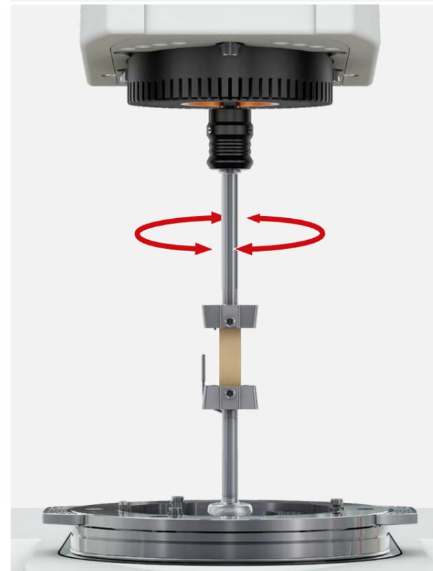
このモードでは、リニアドライブを固定し、回転ドライブを使用してせん断ひずみやせん断応力を制御します。円柱状/短冊状サンプル用測定システム(SRF/SCF)や、プレートプレートまたはコンプレートなどの測定システムと組み合わせることで、ねじりモードの動的粘弾性測定やレオロジー測定の可能性を広げます。
