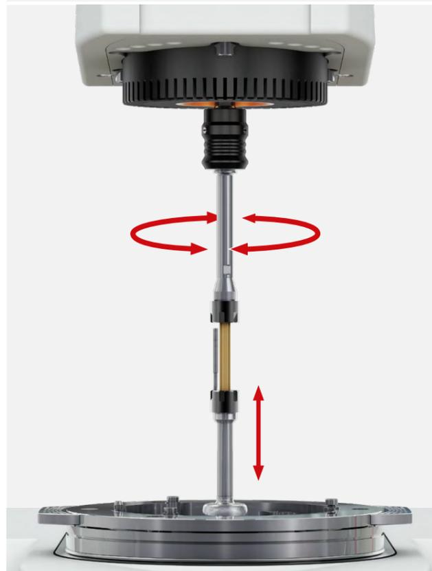
円柱状/短冊状サンプル用測定システム(SRF/SCF)を用いたリニアドライブと回転ドライブによる複合測定では、温度、周波数、時間、湿度の関数としての複素ヤング率( $E^*$ )と複素せん断弾性率( $G^*$ )を1度の試験で求めることができます。これにより初めて、等方性材料のポアソン比を単一サンプルで正確かつ迅速に測定できるようになりました。また、複合材料などの異方性材料を調査する場合は、方向に依存した迅速な特性評価が可能のため、サンプルの特性をより包括的に分析することができます。
