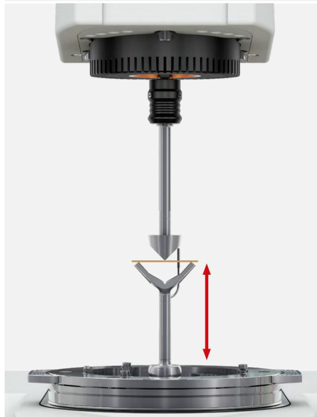
このモードでは、回転ドライブを固定し、リニアドライブを使用して荷重または変位のいずれかを制御します。三点曲げ、シングルカンチレバー、デュアルカンチレバー、引張DMA用治具、圧縮DMA用治具などの測定システムと組み合わせることで、従来の動的粘弾性測定を、可能な限り正確に行うのに適しています。さらに、このモードでは、クリープ回復試験、一定の応力やひずみ下での測定、熱機械分析などを行うことができます。
