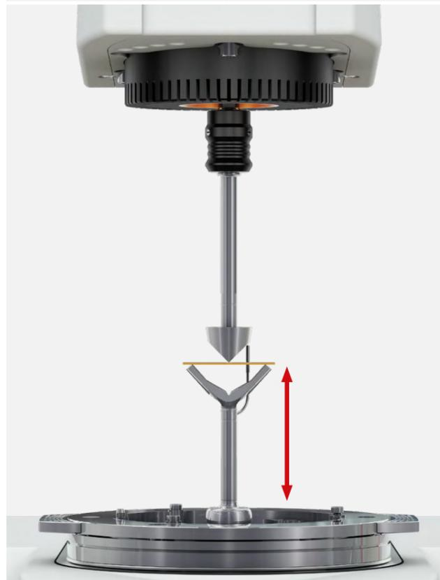
在该模式下, 旋转马达置于一个固定位置, 而线性马达则用于控制力或位移。配合测量夹具(如三点弯曲、单悬臂、双悬臂、拉伸、压缩模式下的 DMA 夹具)使用时, 该模式适用于进行精确的“经典”动态机械分析。此外, 您还可以在该模式下执行蠕变恢复测试、恒定应力或应变测量以及热机械分析。
