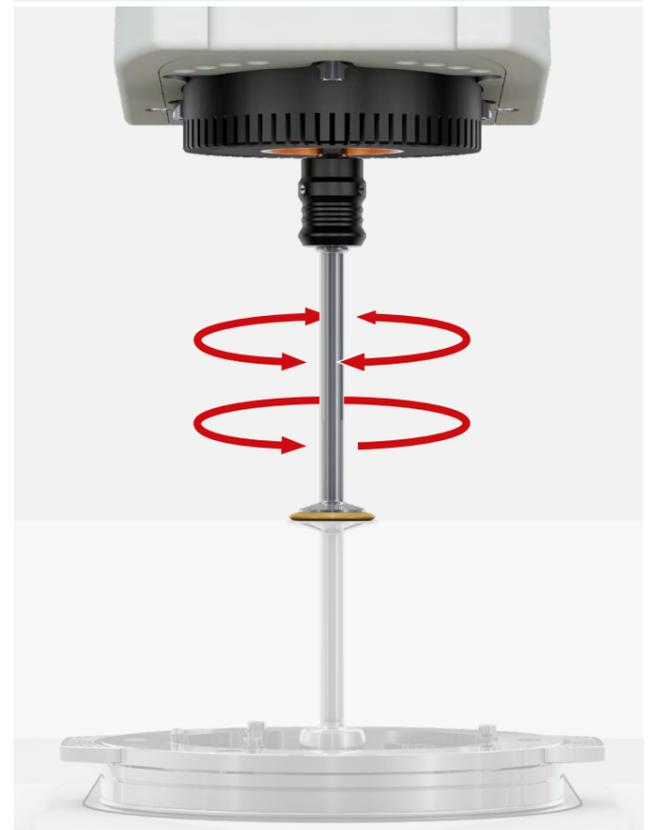
在该模式下, 移除了线性马达, 测量设备转变为传统的旋转流变仪。移除了线性马达的设备可以装配任何测量系统、控温系统和/或安东帕 MCR 系列流变仪现有的专用附件, 以便对您的样品进行标准和复杂的流变分析。移除线性马达后, 可在下面安装第二套旋转马达, 以利用流变仪的所有测量模式进行高级流变测量。
