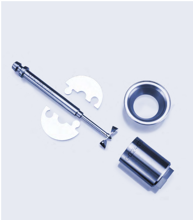
PFC 10 pour les mesures de base de l'énergie d'écoulement à des températures élevées
