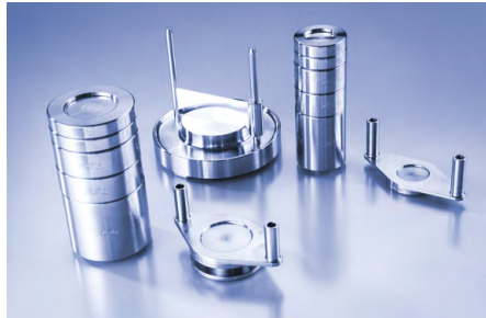
Banc et Masses pour petite et grande cellule de cisaillement pour la préparation sans bloquer votre dispositif
