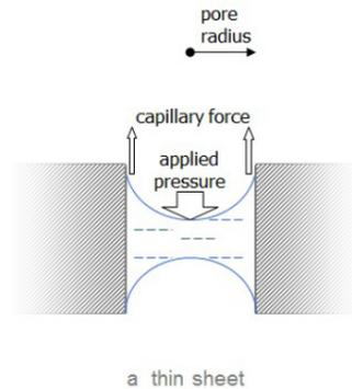
毛细管流动法孔径分析(或称排液法)的基本原理是:加压使孔道内的浸润液流出孔道,并测量此时施加的气体压力。设备需要同时测定通过孔道的气体压力和流速,以获取通孔的孔径分布。
