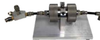
我们独有的片状样品支架，可用于不规则片状样品或岩芯在低压下的测量。使用一个压力源，能使气体穿透材料的同时密封样品外部。
