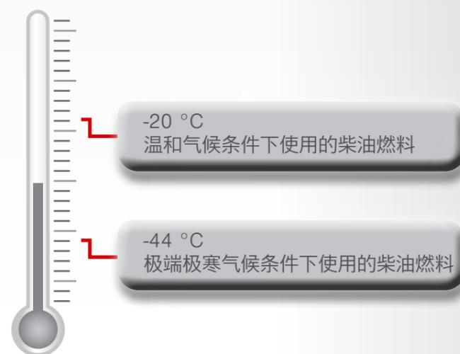
炼油厂有许多方法来提高燃料的低温流动性能,比如用添加剂处理燃料或者从蜡含量较低原油中提炼燃料。
