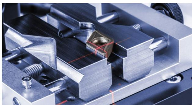
ここで、レーザーで測定する領域をターゲットにします。押し込み点は、2本のレーザーラインの交点に設定されています。カメラを追加して、下の領域をより詳しく観察します。
