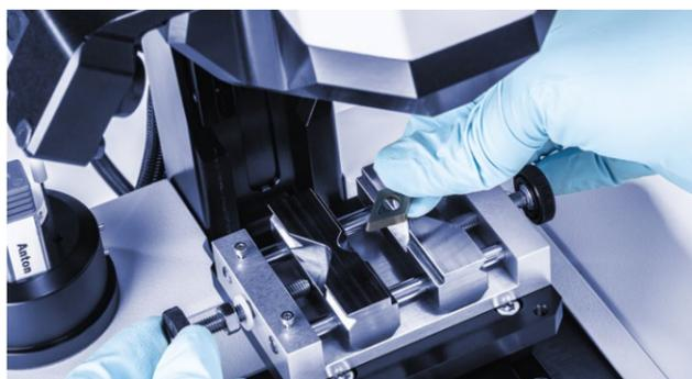
まずは、各装置のアクセサリキットに入っている石英ガラス製リファレンスサンプルを使ってください。次に、自分のサンプルをマウントします。
