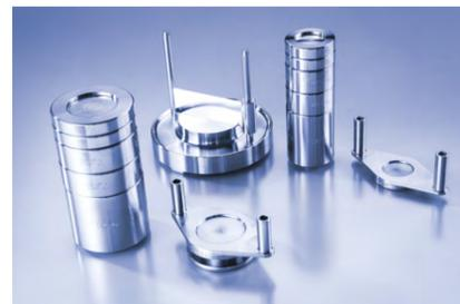
**Bank und Gewichte** für die kleine und die große Scherzelle, um Zeitverfestigungsmessungen durchzuführen und das Gerät nicht zu blockieren
