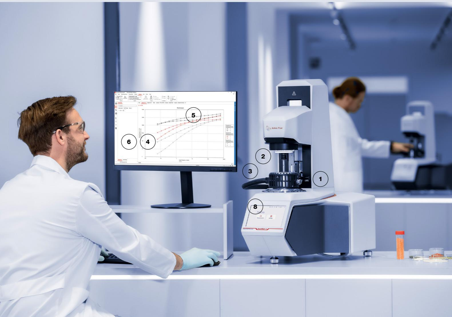
1. **Toolmaster:** Reconocimiento automático de la geometría de medición y la celda.
