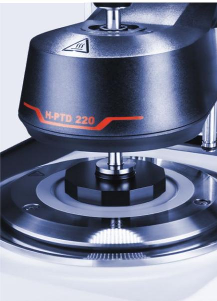
**Controle da temperatura Peltier para sistemas de placas paralelas (P-PTD 220) e capa para até 220 °C (H-PTD 220)**
