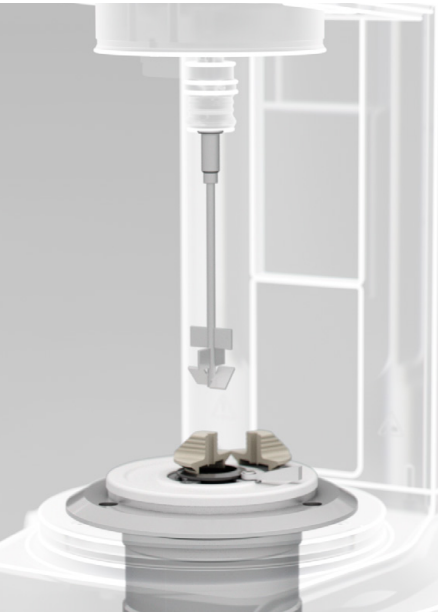
淀粉测量单元 用于分析淀粉糊化行为的淀粉测量池,能够模拟食品生产过程中的温度和压力条件,其样品量非常小,约为 18 mL,并可选配最高耐受 30 bar 和 160 °C 的淀粉高压测量单元。
