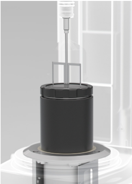
建筑材料测量单元 (BMC) 使用 BMC,能够可靠测量含大颗粒样品的流动特性 (>1 mm),这些样品通常存在于建筑材料、食品或浆料中。该测量池具备耐磨特性,可防止样品打滑,优化混合效果,避免样品分层。
