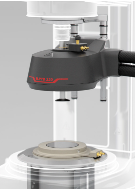
介电流变连用装置 (DRD) DRD 将流变测量与介电谱/阻抗谱分析技术相结合。它们通过介电谱解析深入揭示材料内部结构信息。典型应用包括电池浆料、粘合剂、树脂和极性材料的表征。可与各种型号的LCR测试仪连接使用。
