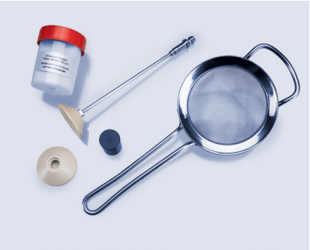
采用可重复使用、自由流动的置换粉体,能对样品量在 0.3 cm³ 至 25 cm³范围内的固体包裹密度进行简单安全的表征。当样品量至少为总装填量的 25% 时,可确保体积测量的精确度,重复性高达 1%。 结合气体比重瓶测量法,可测定固体材料的绝对密度、孔隙率和比孔容。
